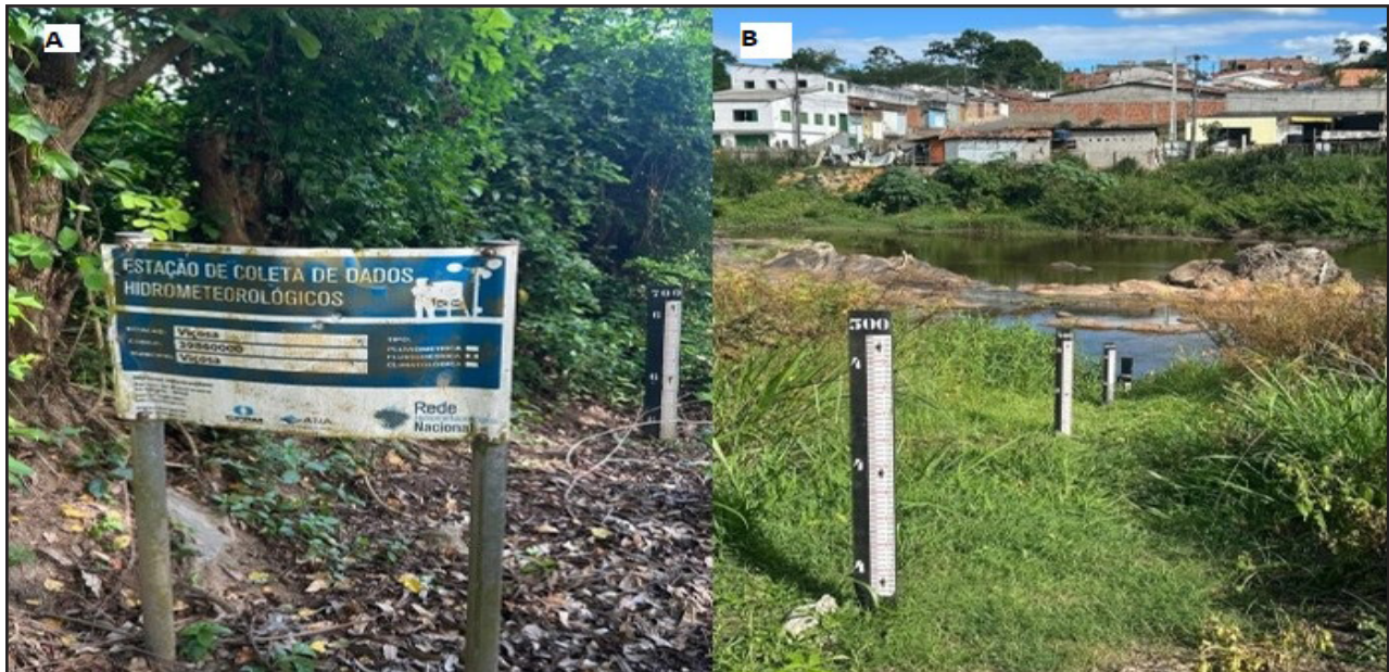
Figura 12 – (A) Placa de identificação da estação de coleta; (B) Régua de nível na margem do rio e ao fundo outra comunidade ribeirinha (Rua Vigário Silva)
