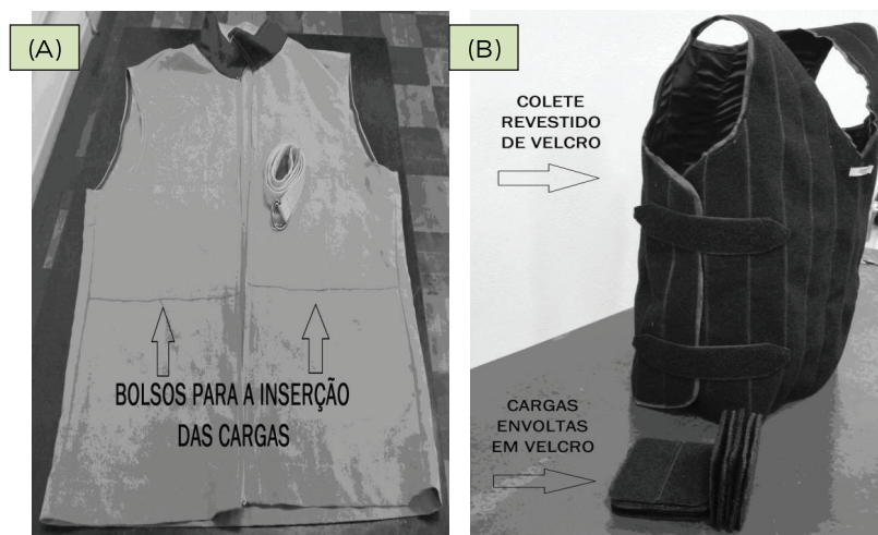
Foto da esquerda, colete A de material gabardinado; foto da direita, colete B de velcro juntamente com as cargas que foram inseridas nos coletes
