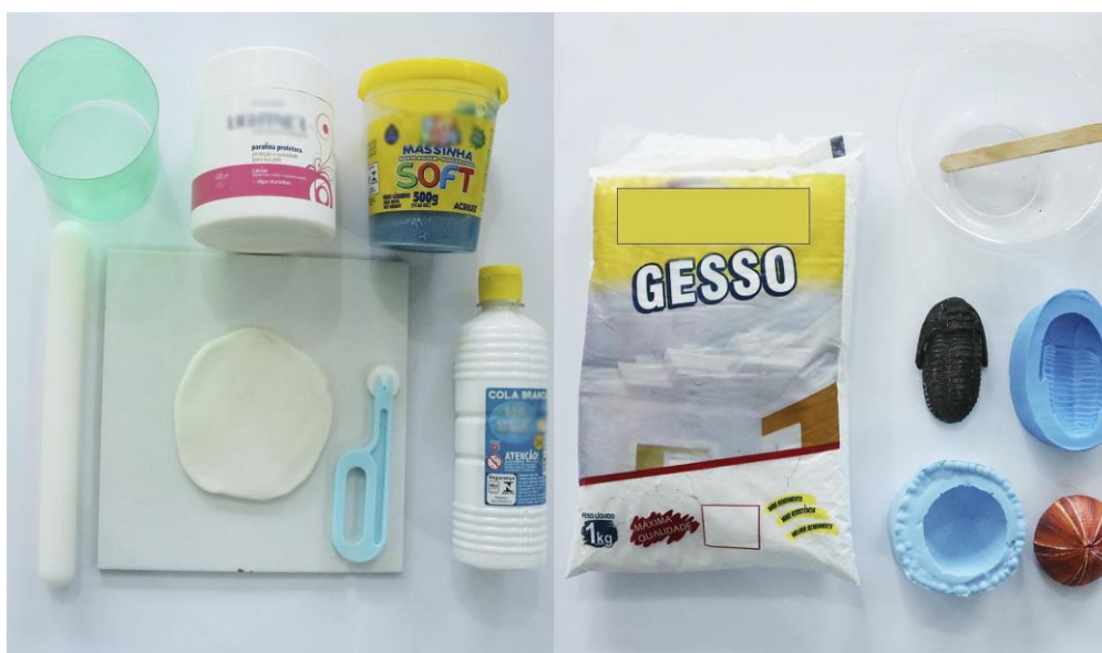
Figura 1 - Materiais usados no processo de fabricação dos moldes de réplicas fósseis.
