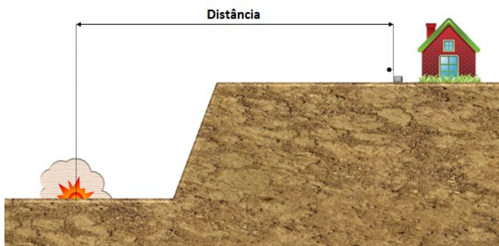
Figura 5 - Representação entre o ponto do desmonte até o ponto de coleta.
