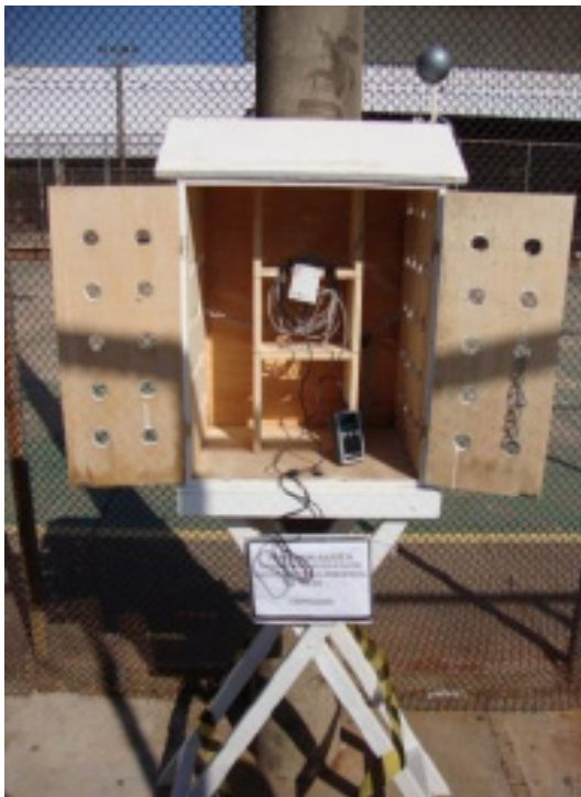
Figura 7 – Abrigo micrometeorológico para o Hobo
