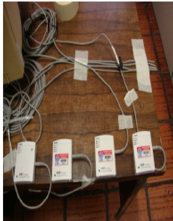
Figura 8 – Calibração dos Hobos
