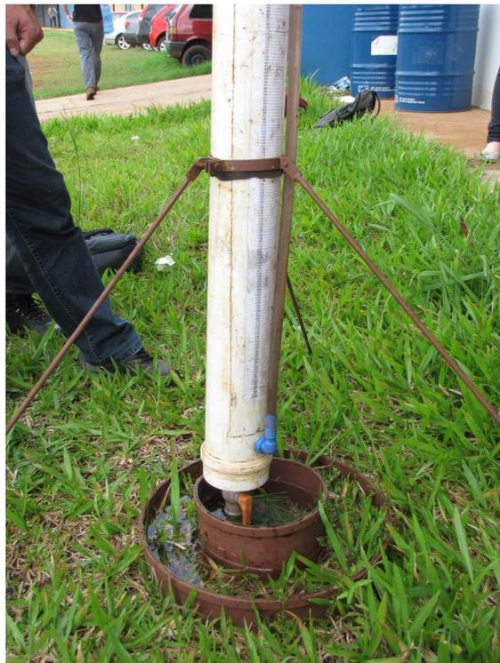
Figura 2. Infiltrômetro de anel
