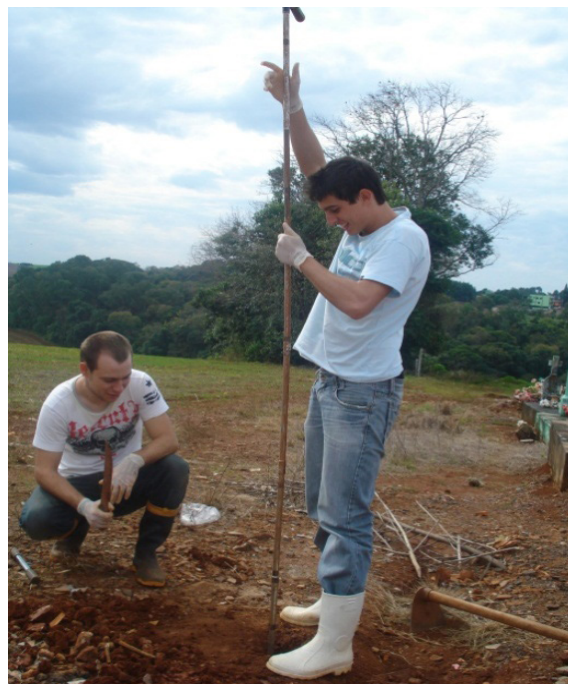
Figura 2. Tradagem manual nos pontos amostrados em solo entre 0 e 300 cm de profundidade.
