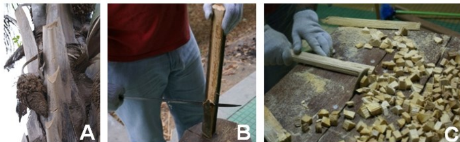
Figura 03. Beneficiamento do pecíolo de inajá. Detalhe dos pecíolos extraídos (A); Remoção da Epiderme (B); Produção de Cavacos (C).
