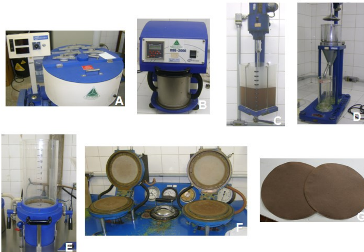
Figura 05. Após cozimento, na formação da folha. Máquina de refino (A); Desintegrador (B); Homogeneizador de polpa (C); Aparelho de medição do grau de refino (D); Máquina formadora de folha (E); Secador do papel confeccionado (F); Papel produzido (G).
