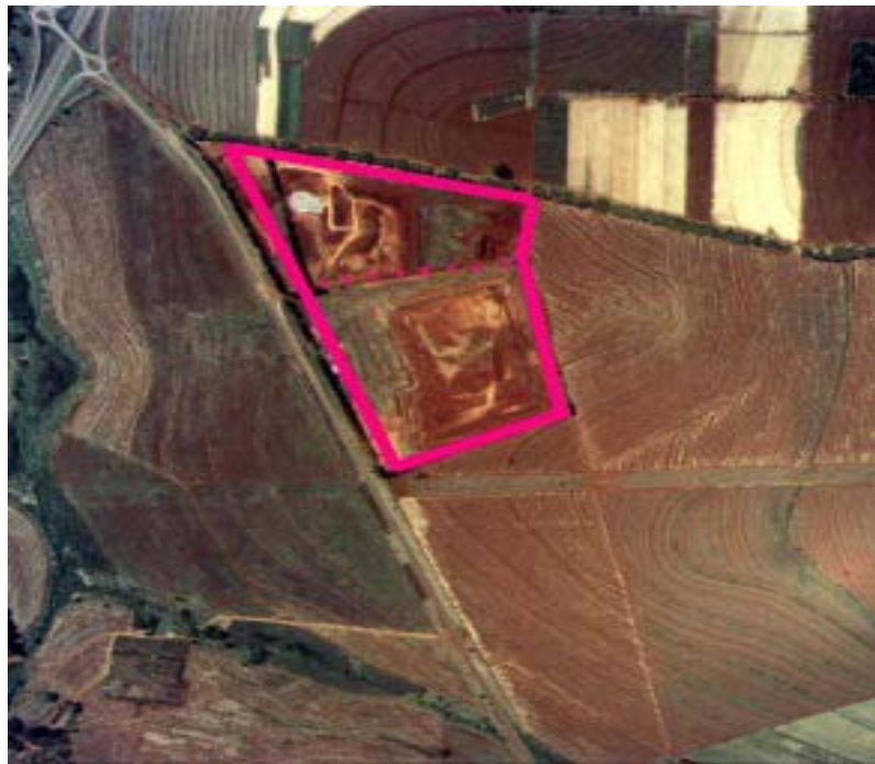
Fonte: Prefeitura Municipal/Seplan (aerofoto Aerocarta escala 1:8.000). FIGURA 19 - Vista do terreno do aterro de resíduo/lixo de Ribeirão Preto, em 2001, mostrando a área original encerrada (inferior) e a área de expansão (superior)
