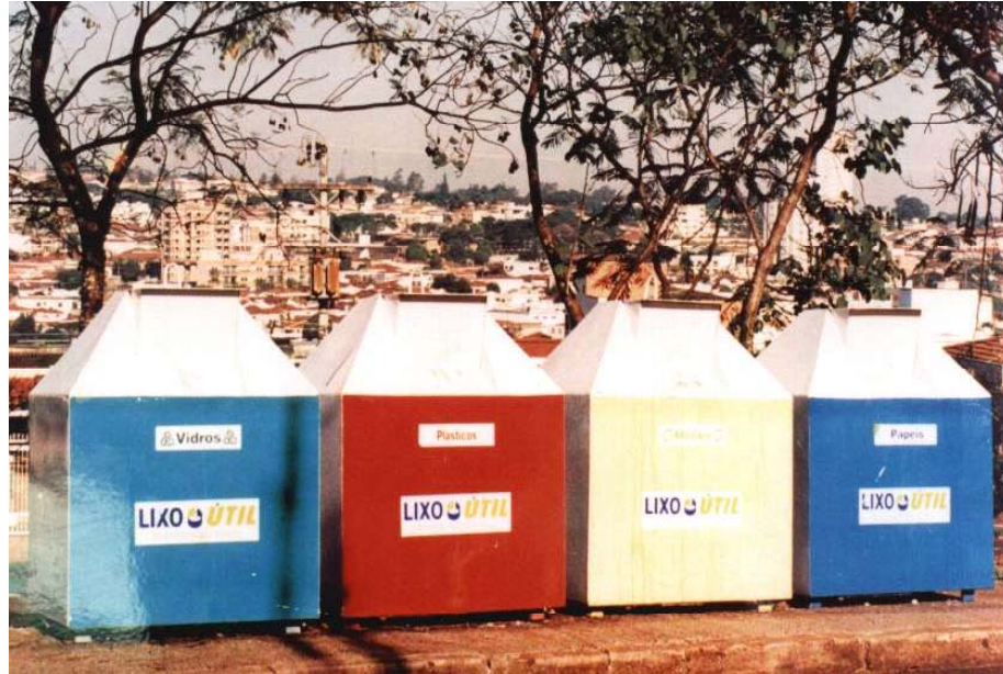
FIGURA 14 - Vista de um PEV - posto de entrega voluntária com recipientes metálicos para recepção de resíduos potencialmente recicláveis
