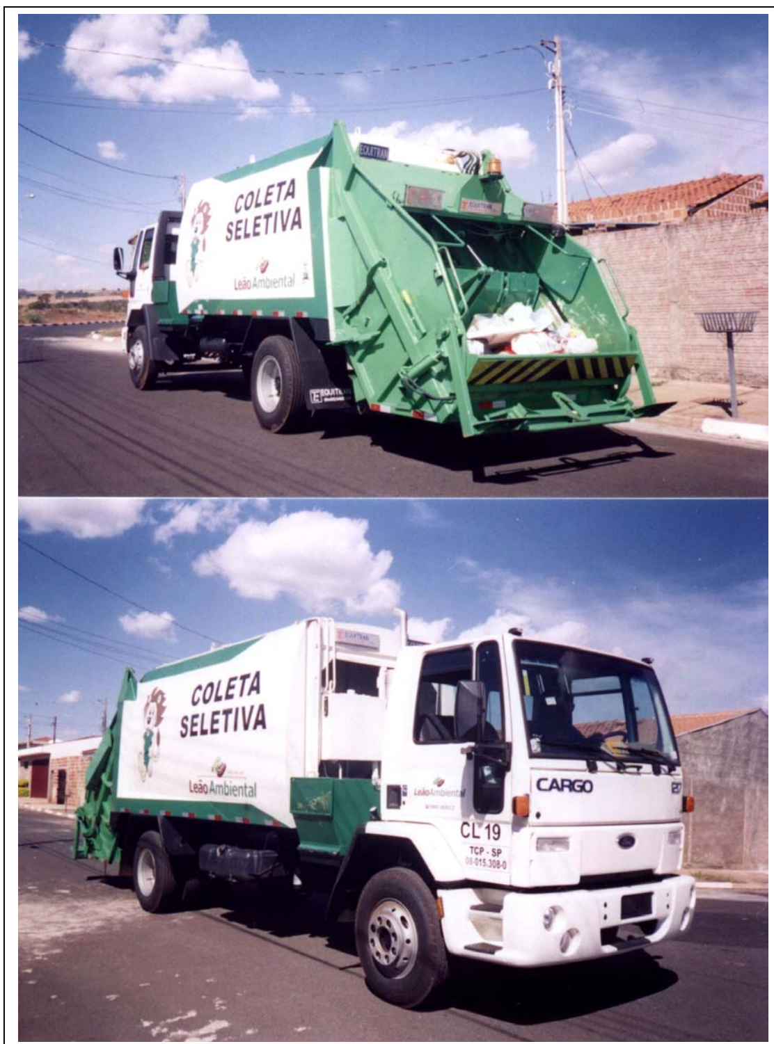
FIGURA 13 - Caminhão utilizado na coleta seletiva de Ribeirão Preto equipado com dispositivo coletor/compactador e recipiente para vidros e metais ferrosos
