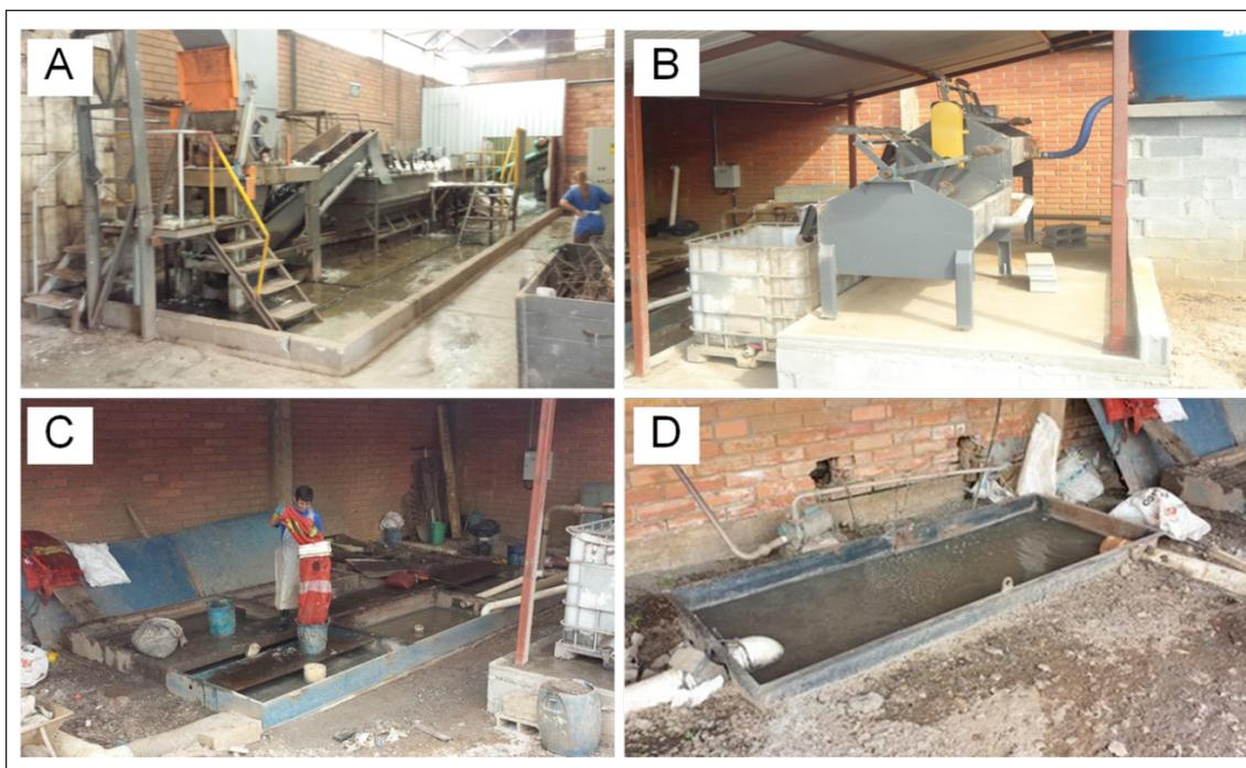
Figura 2 - Proceso de lavado del plástico y tratamiento de efluentes: Proceso de lavado del plástico, a través del tanque de la lavadora (A); Cribas rotativas (B); Tratamiento Primario (C) y Tratamiento Secundario (D).
