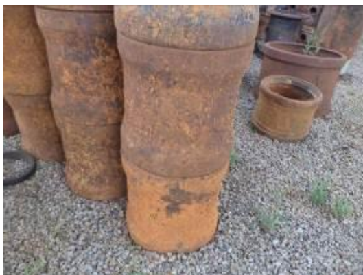
Figura 2 (a) e Figura 2(b): Detalhe do enferrujamento nas conexões.
