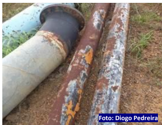
Figura 2 (a) e Figura 2(b): Detalhe do enferrujamento nas conexões.
