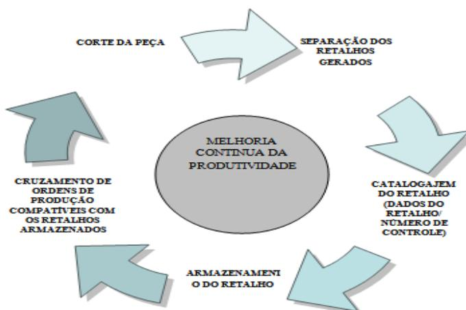
Figura 10 – Fluxo retroalimentado do aproveitamento de sucata de chapas de aço
