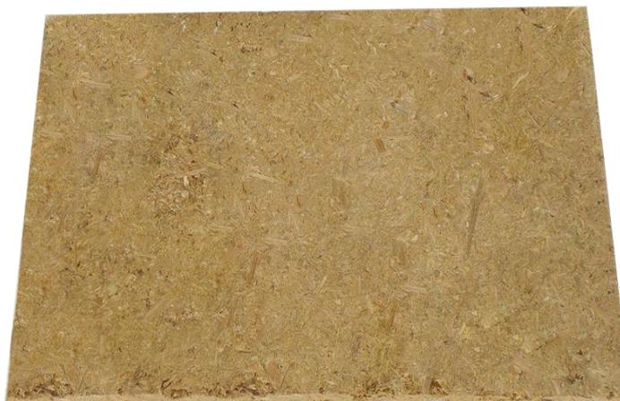
Figura 3 – Chapa recomposta de bambu fabricada com adesivo poliuretânico. Fonte: Autor (2012).
