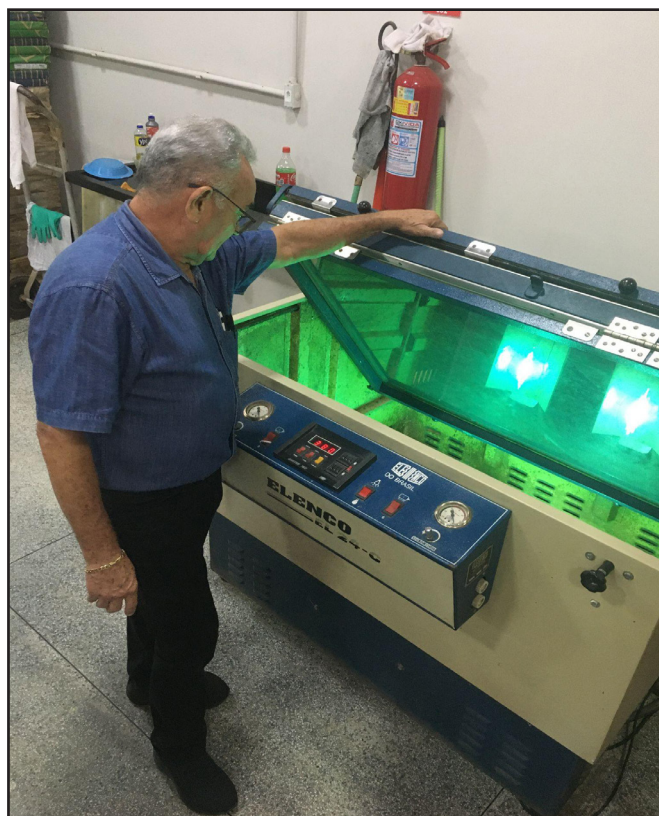
Figura 2 – Mestre Zuca gravando uma chapa de offset
