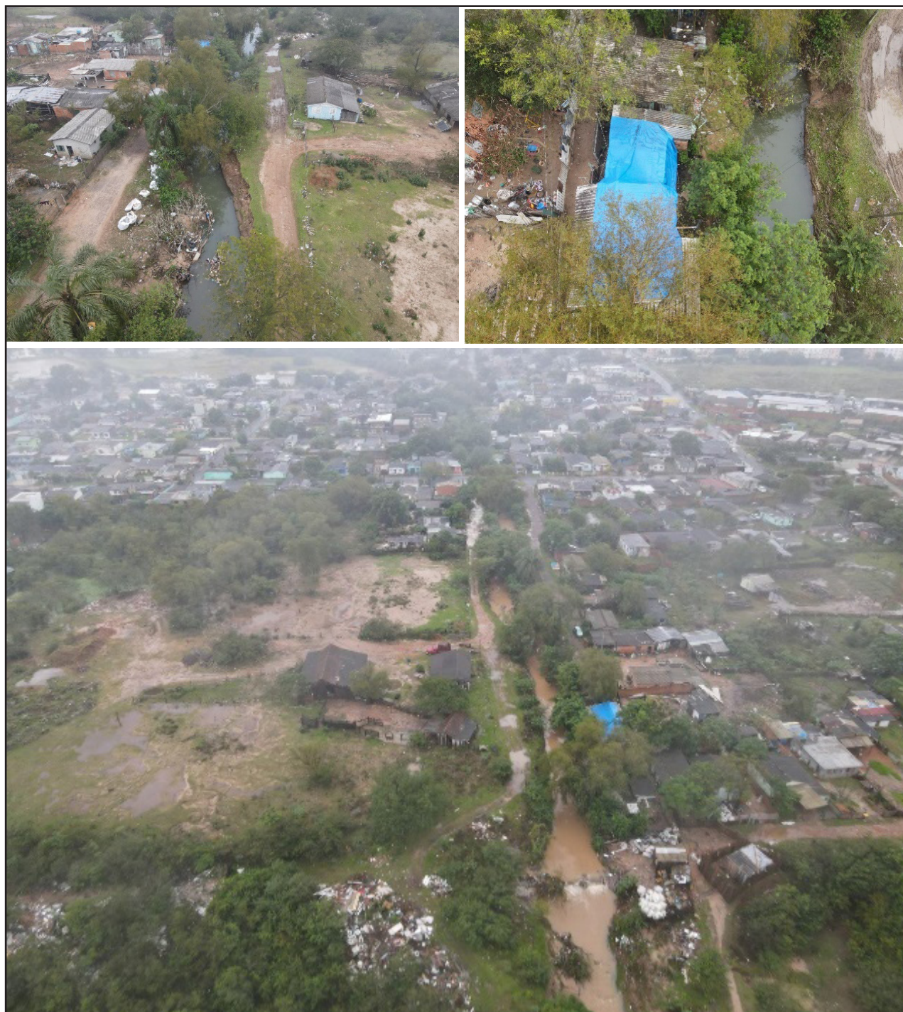
Figura 16 – Fotografia aérea mostrando a ocupação junto ao arroio no segmento indicado por F1, F2 e F3. Moradias muito suscetíveis a processos hidrológicos (F1). Em algumas situações a erosão de margem pode afetar moradias (F2). Presença de área de antigos barreiros (F3)
