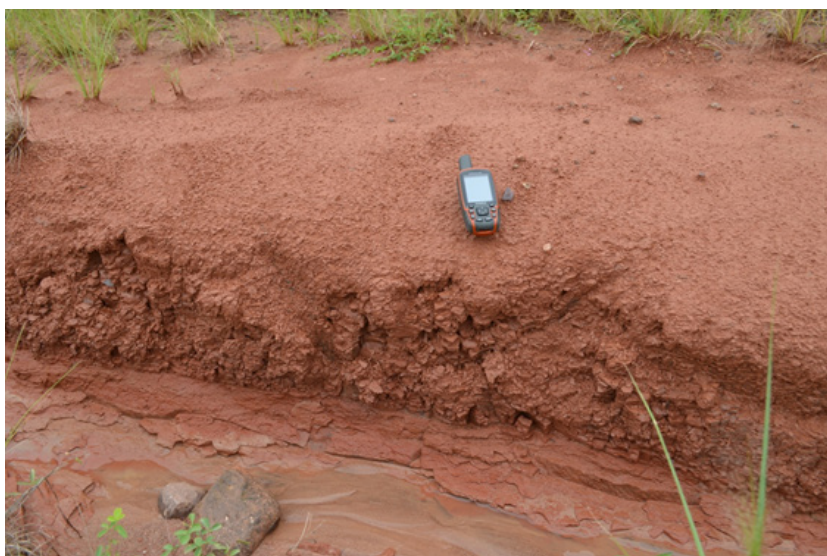
Figura 10 – Intercalações de arenito/lamito da Formação Rio do Rasto (CPRM, 2006). Fotos dos autores no Município de Dom Pedrito
