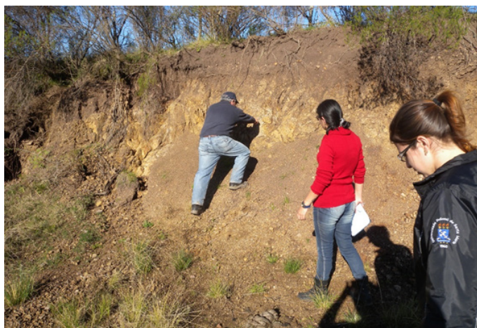
Figura 5 – Ignibrito alterado aflorando em corte de estrada no interior do município de Dom Pedrito na unidade Maciço cristalino.
