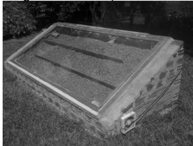
**Figura 4 – Vista do Coletor solar pronto.**
