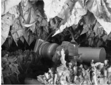
**Figura 8 – Psicrômetro tipo bulbo úmido e bulbo seco.**
