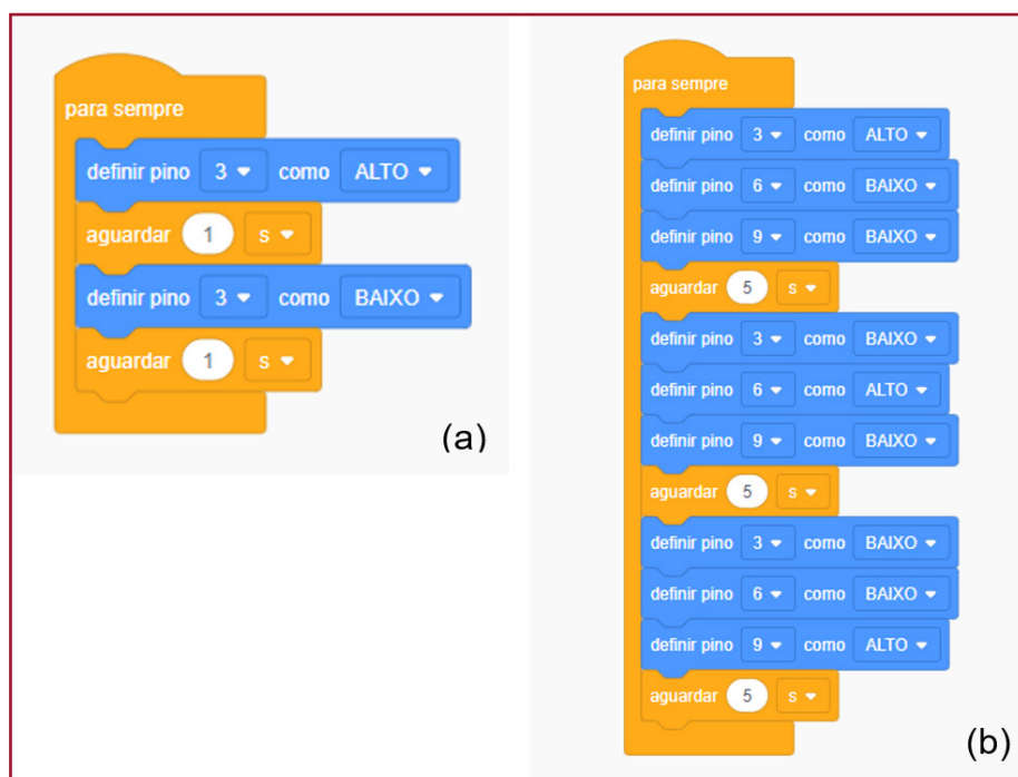
Figura 4 - A Figura 4(a) indica o código do “pisca LED”; Figura 4(b) o bloco do semáforo
