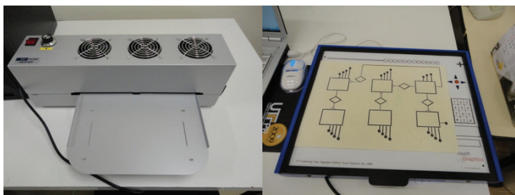
Figura 3 – Impressora de relevos (à esquerda) e mesa de relevos táteis (à direita).
