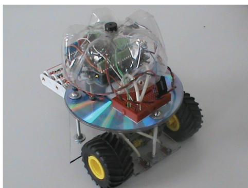
**Figura 2:** Robô seguidor de linha UAI-Le projetado para as aulas de robótica.
