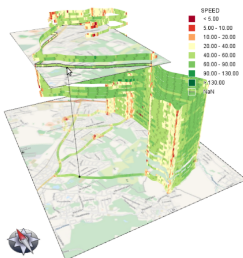
Figura 4. Visualização 3D de dados de trajetórias, envolvendo as dimensões espacial e semântica, em que o gradiente de cores refere-se a informação de velocidade [Tominski et al. 2012]
