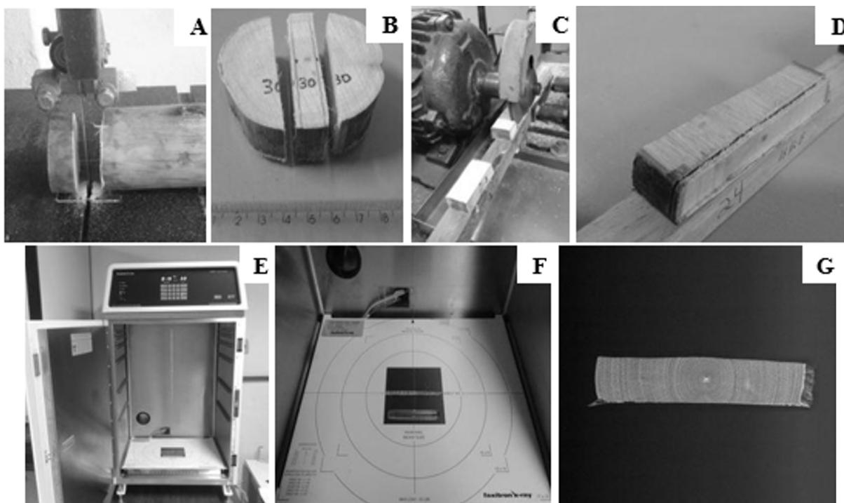
FIGURA 2: Obtenção das imagens digitais do lenho de *Eucalyptus grandis* em equipamento de raios X (A, B, C e D) corte e preparação da amostra transversal do lenho (2 mm, espessura); (E, F) equipamento de raios X LX-60; (G) imagem digital do lenho.
