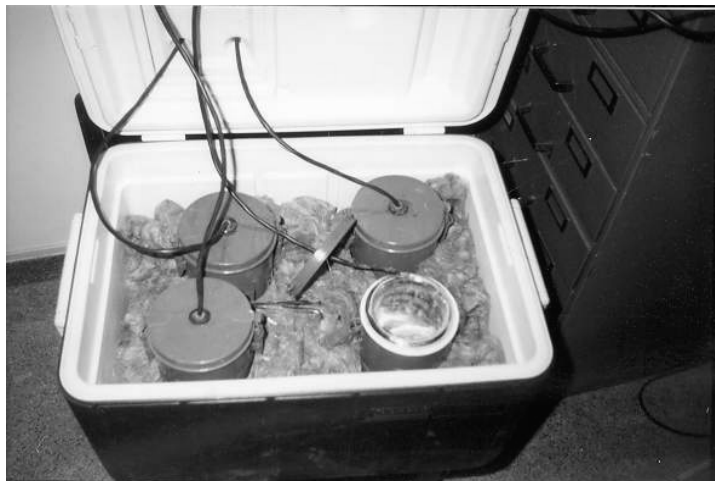
FIGURA 1: Sistema utilizado para armazenar as amostras para o ensaio de termometria FIGURE 1: Used system to store the samples for the aptitude assay.
