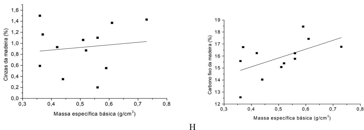
FIGURA 4: Teor de cinzas (G) e do teor de carbono fixo (H) em função da massa específica básica.
