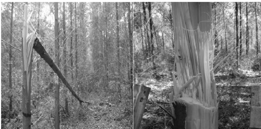
FIGURA 3: Região de ruptura das árvores durante o teste de resistência à quebra.
