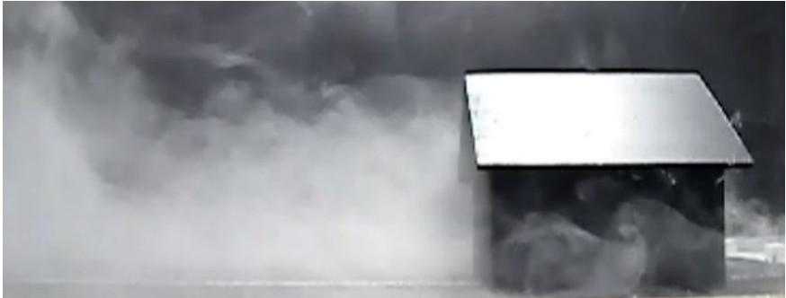
Figura 4. Vista lateral dos vórtices ferraduras na face esquerda do obstáculo e região de esteira próxima: \theta = 0^\circ e Re = 4591 .
