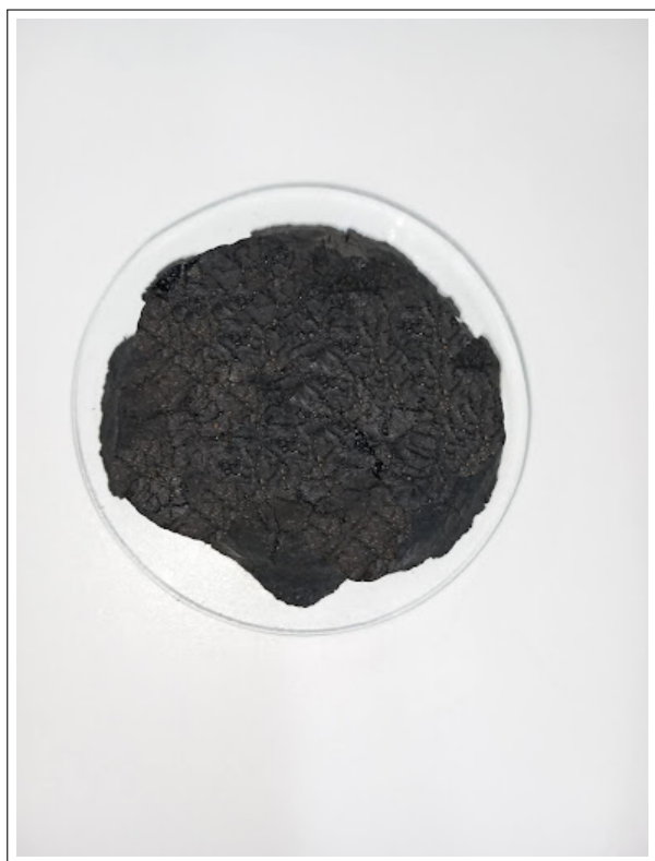
Figura 2 – Estrutura física final do polímero condutor desenvolvido, após a incorporação das nanopartículas de ferro no PVA
