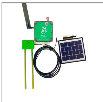
Figura 2 – Imagem do conjunto TDR utilizado
