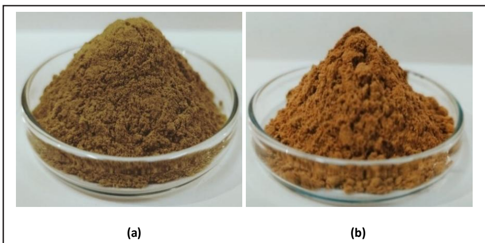
Figura 1 – Argilas bentonitas após processo de moagem: (a) in natura ; (b) calcinada
