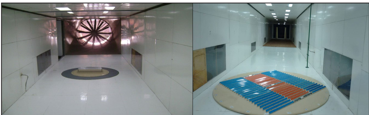
Figura 1 – Modelo do painel isolado (escala 1/10) e modelo do setor do parque (escala 1/75)
