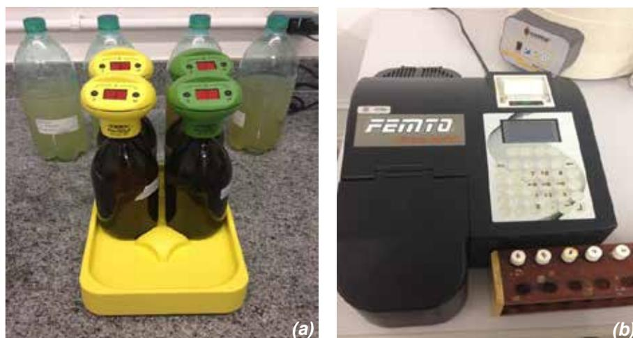
Figura 6 – Equipamentos utilizados para avaliação de parâmetros (DBO e DQO respectivamente)
