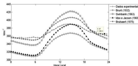
Figura 2: Ciclo diurno médio da radiação de onda longa atmosférica experimental e calculada usando as equações da Tabela 1 e os parâmetros ajustados A e B da Tabela 2.
