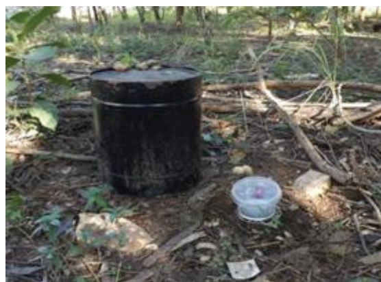
Figura 3 - Armadilha de álcalis: balde metálico e pote contendo KOH para captação de CO 2 do solo sobre suporte metálico. Fonte: autores
