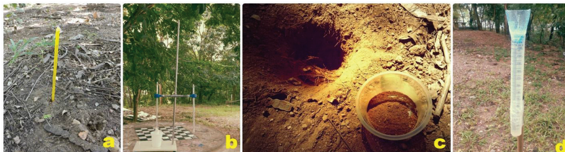
Figura 2 - a. Termômetro analógico; b. Psicrômetro artesanal; c. Coleta de solo; d. Pluviômetro artesanal. Fonte: autores
