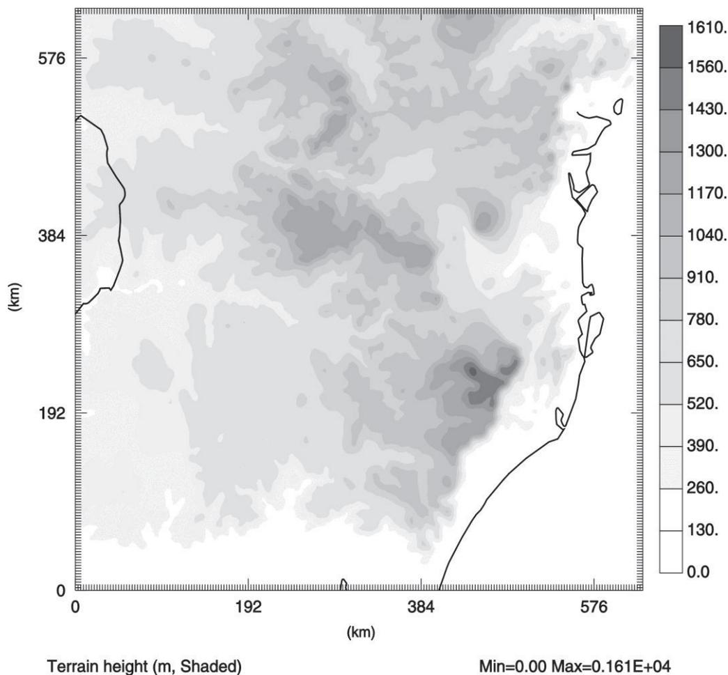
Figura 1- Domínio horizontal utilizado na simulação numérica do campo de temperatura do ar. Os tons de cinza representam o relevo (legenda em metros na direita do mapa) definido pelo ARPS com resolução de 3 km X 3 km
