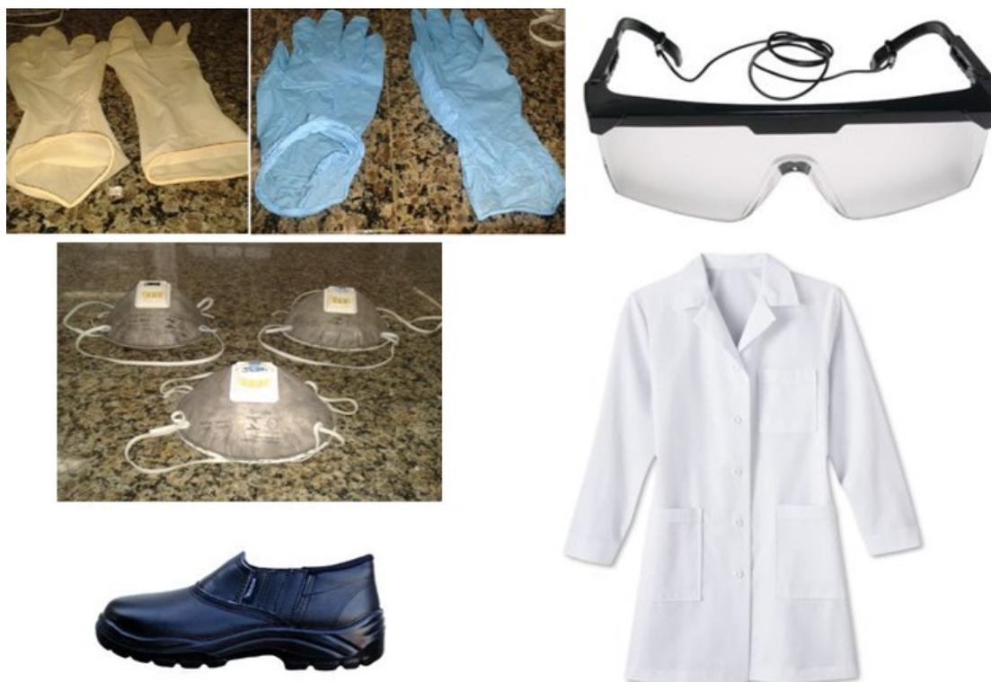
Figura 1 - EPIs utilizados pelo técnicos laboratoriais na análise da qualidade de água.
