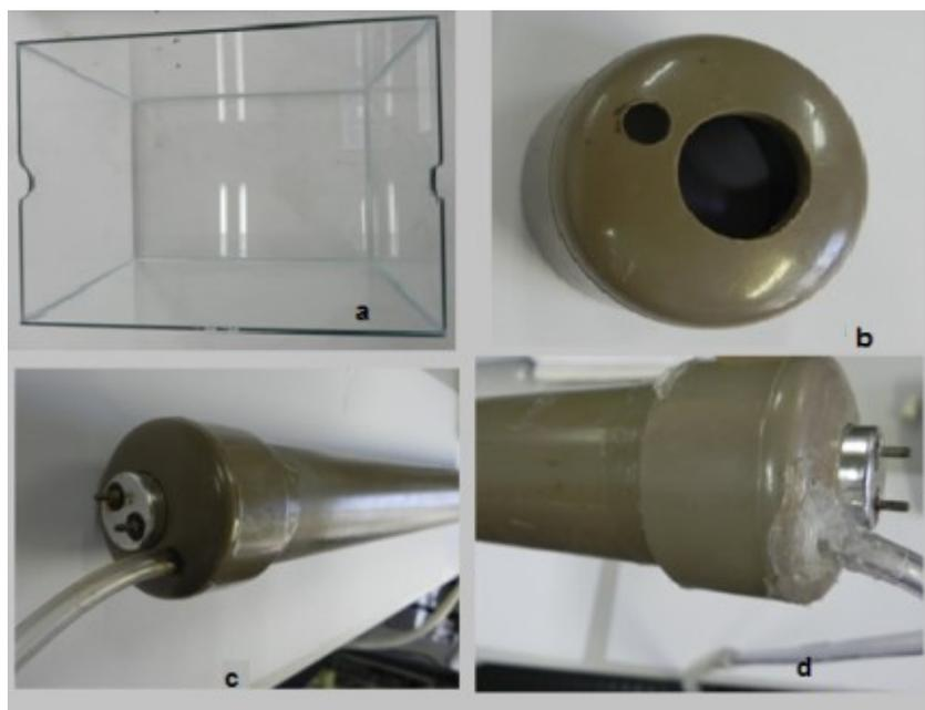
Figura 2: Fotos ilustrativas detalhadas do processo de montagem do sistema contendo atmosfera de ozônio. (a) Cuba de vidro, que pode ser um aquário retangular; (b) tampão de PVC contendo um furo no centro de diâmetro igual ao da lâmpada e outro com diâmetro igual ao da mangueira de aquário; (c) uma das extremidades montadas e (d) seladas com cola de silicone.
