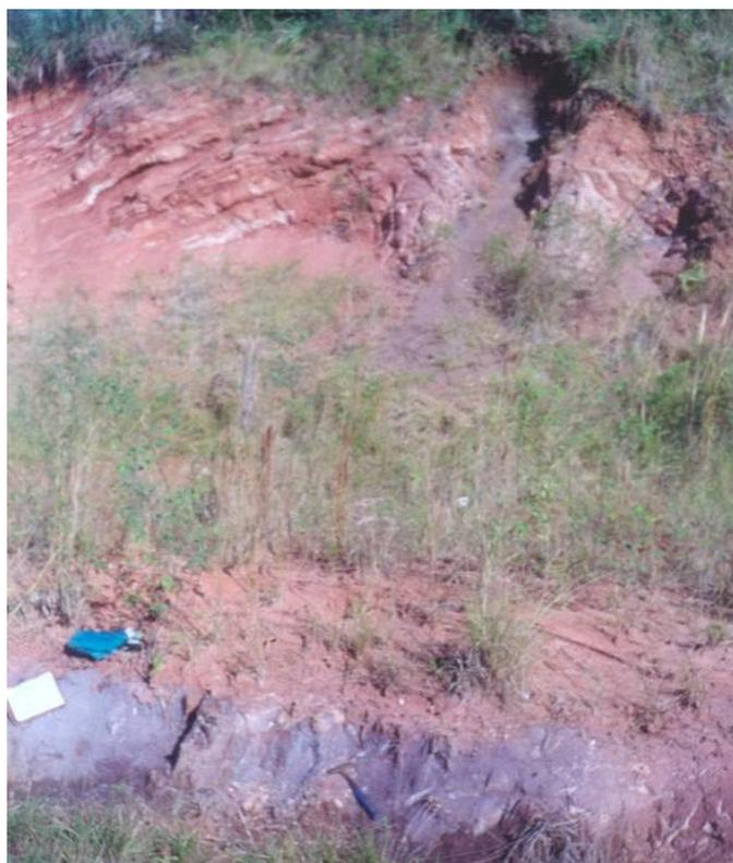
Figura 3- Dique discordante seccionando camadas vermelhas silto-argilosas da Formação Santa Maria, (Aquicluda Alemoa), notar dique de coloração lilás distinta. Município de Venâncio Aires, corte Estrada RST -287 na localidade Arroio Castelhanos.
