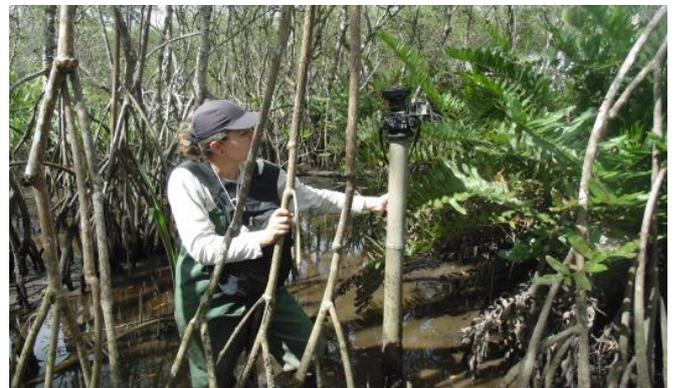
Figura 1: Câmera fotográfica acoplada com uma lente “olho de peixe”, instalada no manguezal da Barra do Ribeira – Iguape/SP.
